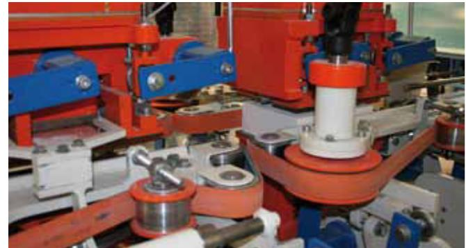
**Инновации в каждой детали - WKB-Combi-Embosser** – комбинированный узел колки и рустирования, выполняющий две операции за один рабочий ход: раскол кирпича и одновременное рустирование половин кирпича с ложковой и тычковой сторон.
