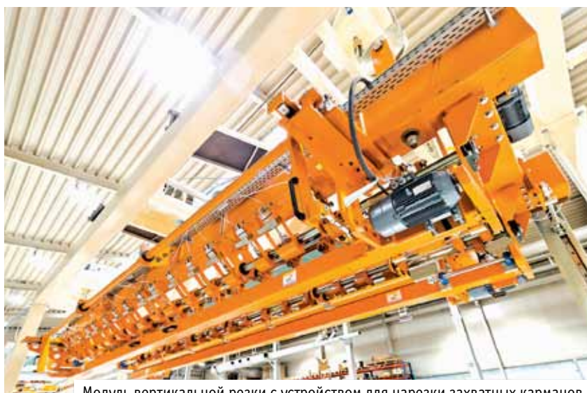
Модуль вертикальной резки с устройством для нарезки захватных карманов
