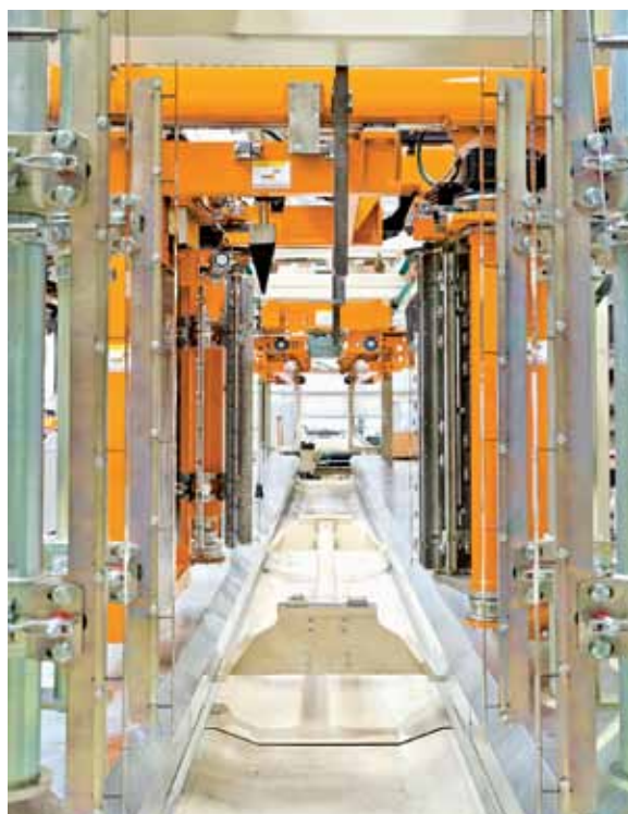
Линия резки для блоков /панелей толщиной от 50 до 500 мм
